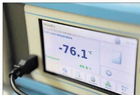
Das Display zeigt an, ob die Temperatur stimmt. Bei einem Stromausfall wird ein Alarm ausgelöst, und ein Akku übernimmt vorübergehend die Kühlung.
