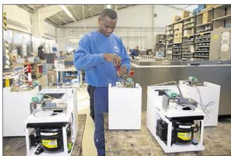
In der Produktion ist bei Fryka noch viel Handarbeit angesagt: Das Foto zeigt Mitarbeiter Alex Adjeje bei der Montage von Durchlaufkühlern.
